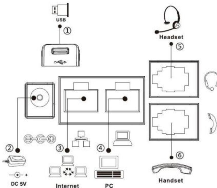
注意：X2C有两个RJ9耳机接口，其中上面的是正常通话的耳机接口，下面是用于监听的耳机接口，即只能听无法说话。
