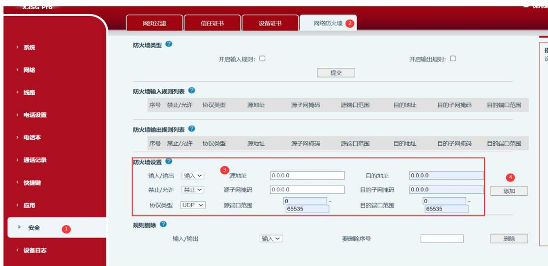
注意事项：如上两步设置后表示只允许 172.18.1.88 这个设备(PBX 服务器)发送到话机的数据，其他 IP 的主机是无法发送数据给话机的，这样就只有 PBX 发送的数据过来话
