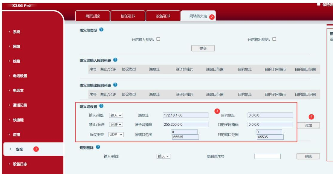
2. 在如上相同位置再添加一条禁止的规则，禁止除服务器 IP 之外的 IP 发送数据给话机，设置如图
